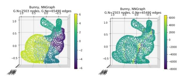
原信号でははっきりと色分けされてグループに分かれていた信号が、フィルタリングを行うことで、全体的にぼやけています。特にグループの境界部分でその傾向が顕著です。 フィルタリングによって 2 つ隣の頂点の信号まで含めて重み付き和を取ることは、それらの頂点の情報の平均を取る操作に相当します。つまり、全体的に同じような値に近づくことになるので、グループの境界が分かりにくくなります。右の図でこのことが反映されていることが分かります。これはグラフ信号を滑らかにする処理なので、使ったフィルタも低域通過フィルタです。
